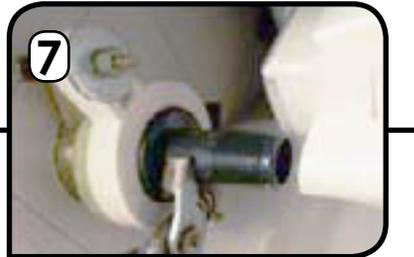
Tirar hacia delante el drenaje canal con unos alicates de seguridad por adentro de la caja hasta que se encuentre con drenaje interno
