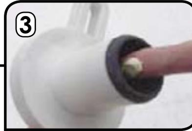
Lubricar acoplador de lado macho
